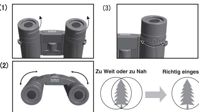
Um das maximale Leistungsvermögen des Fernglases nutzen zu können, müssen Sie es zunächst Ihrer eigenen Sehschärfe anpassen. Dies wird durch Justieren der Augenmuscheln und des Augenabstandes sowie der Einstellung der Dioptrien und der Fokussierung erreicht. Das Sichtvermögen ist u.a. vom eigenen körperlichen Zustand, der Umgebung und vom Wetter abhängig.
