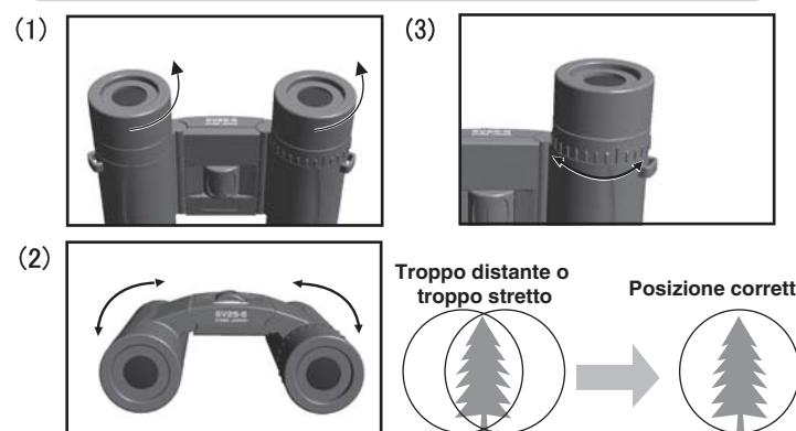
Per ottenere le prestazioni migliori del binocolo, bisogna ottimizzare la propria messa a fuoco. Questo avviene mediante regolazione delle conchiglie, della distanza dell'occhio nonché la messa a fuoco della diottoria e della focalizzazione. La propria vista può essere condizionata dalla condizione fisica, dell'ambiente o dalle condizioni climatiche.
