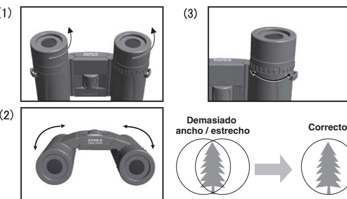
Para obtener el máximo rendimiento, en primer lugar debe ajustar los prismáticos a su propia agudeza visual. Para ello debe ajustar los oculares y la distancia interpupilar, estableciendo las dioptrías y el foco. La visibilidad de la imagen dependerá de sus condiciones físicas, del ambiente circundante y de las condiciones atmosféricas.
